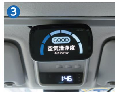
車内の空気清浄状況をセンサーを用いてモニタリングし、結果をタブレットに表示することにより車内空間の「見える化」を実現します。
