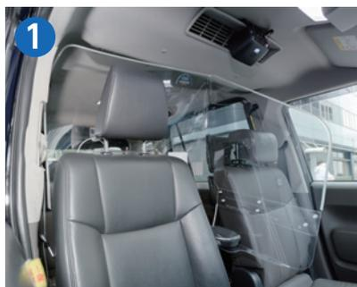
L字型の飛沫防止セパレーターを設置することによりお客様と乗務員の飛沫感染防止に努めています。
