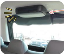
超高性能フィルター(N100)を有し、タクシー車内の微粒子を低減。
