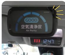
車内の空気清浄状況をセンサーを用いてモニタリングし、結果をタブレット端末に表示。車内の空気の「見える化」を実現。
